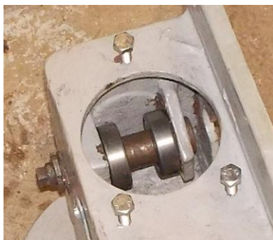
Excentrické kladky v hlavě 3CV
