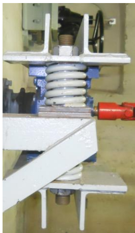
Stávající a navrhované odpružení převodovky GSM
