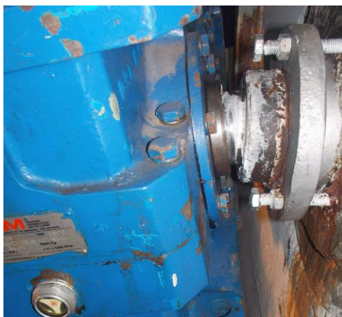
Poškození/deformace stávajícího hřídele prostupu MZV (cca 80 kg)
