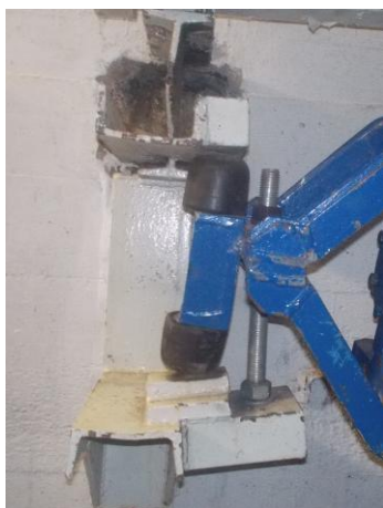
Stávající a navrhované odpružení převodovky GSM
