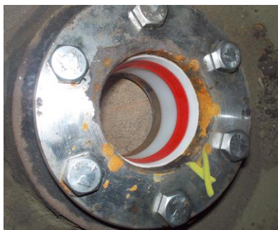
Pouzdro těsnění ve víku s novou přírubou a sadou těsnění
