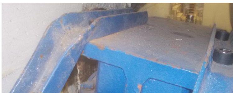
Deformace rámu převodovky.
