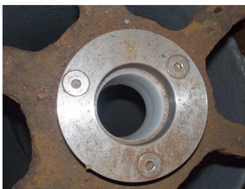
Opravené vodící pouzdro s vložkou
